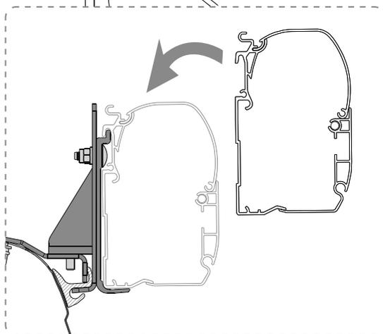
**NL** Voordat u de schroeven aandraait, moet u de positie van de luifel controleren zodat de achterklep volledig kan worden geopend.
