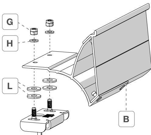
**NL** De borgringen "H" mogen alleen gebruikt worden indien noodzakelijk, om een te grote afstand tussen het dak van het voertuig en de beugel te compenseren.
